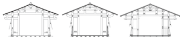
图8 鸾峰桥（左图）、杨梅州桥（中图）、长濑溪桥（右图）的廊屋构架
