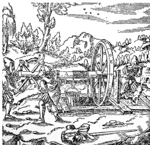
图 7-6 带飞轮的绞车，采自沃尔夫《十六、十七世纪的科学、技术与哲学史》
