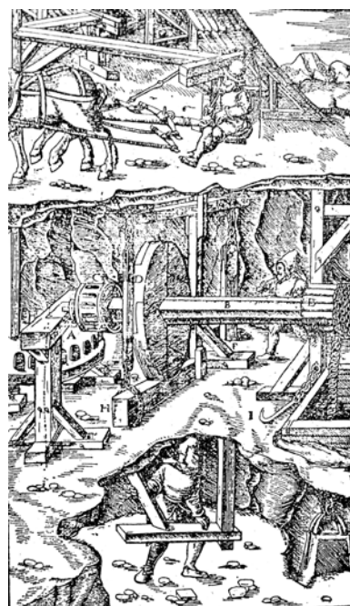
图 7-8 带闸轮的马力绞盘，采自沃尔夫《十六、十七世纪的科学、技术与哲学史》
